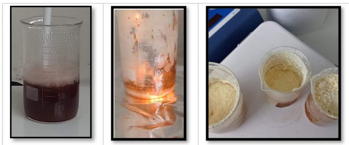
Figura 3. Processo de evaporação do solvente no processo de síntese verde: (a) evaporação, (b) combustão espontânea e (c) pó fino e homogêneo obtido após a combustão da solução
