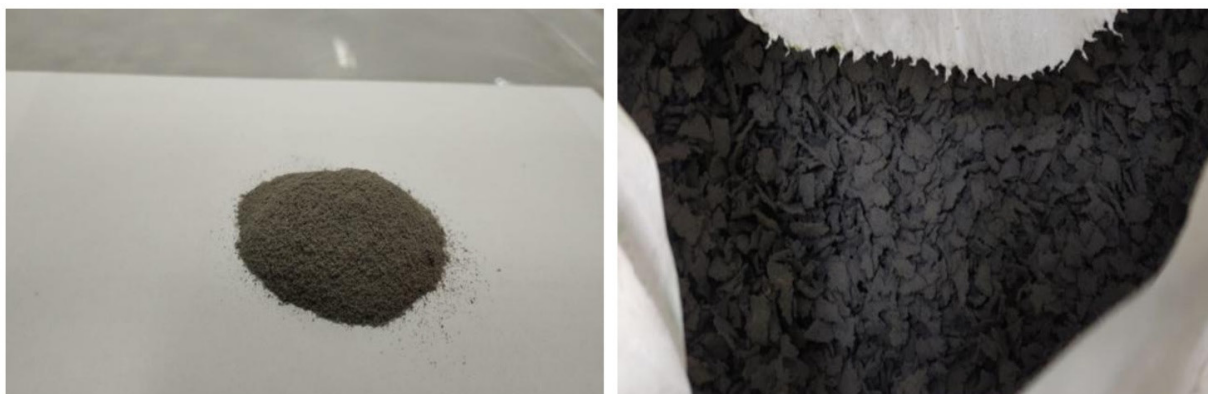
Figura 1. Resíduos de EVA utilizados neste estudo. (a) Resíduo de EVA fino e (b) Resíduo de EVA graúdo
