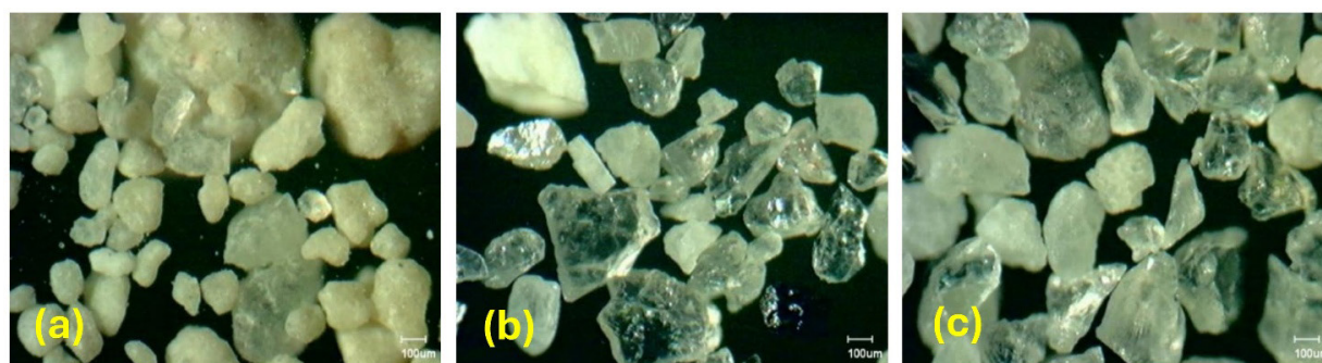
Figura 1. Imagens obtidas em microscópio óptico digital para avaliação morfológica do material retido em malha ABNT #230 (abertura de 63 \mu m). Bentonita Paraná: (a) Moagem grosseira a seco e determinação de resíduo a seco; (b) Moagem grosseira a seco e determinação de resíduo a úmido; (c) Moagem grosseira a seco seguida por dispersão com água e determinação do teor de resíduo a seco
