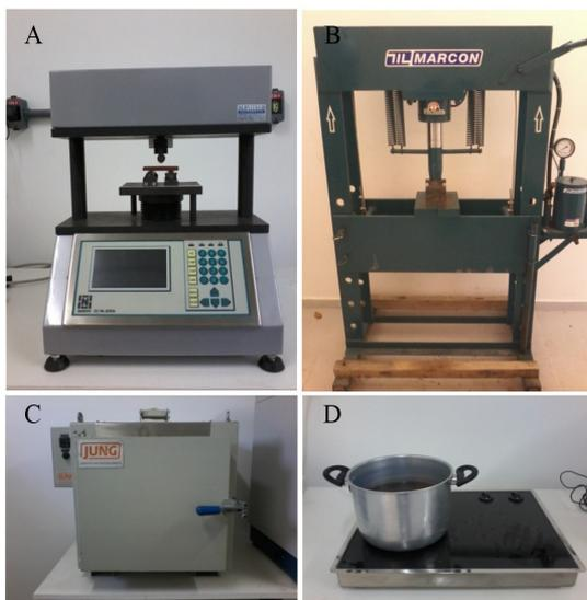
**Figura 3.** (A) Realização do ensaio de TRF; (B) Prensa hidráulica utilizada para a confecção dos Corpos de prova; (C) Forno Jung onde foi realizado as queimas; (D) Realização do ensaio de AA.
