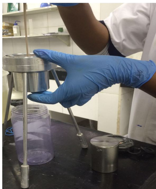
Figura 6. Determinação do tempo de escoamento em Copo Ford.
