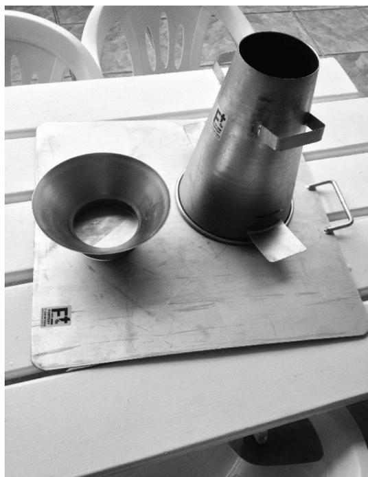
**Figura 3.** Equipamentos para o ensaio de Slump Test.
