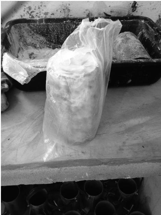
Figura 6. Corpo de prova envolvido pela sacola plástica.
