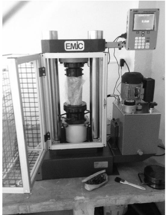
Figura 8. Prensa hidráulica. Emic, PC100C.
