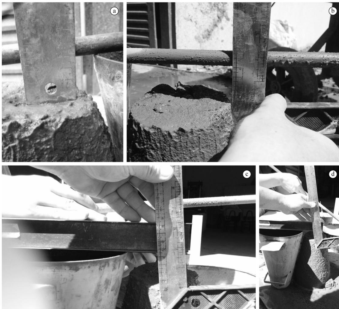
**Figura 14.** Resultados *slump test* para cada traço: (a): 0%, (b): 5%, (c): 25%, (d): 50%.
