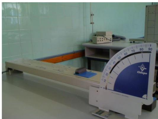
**Figura 8.** Definição do coeficiente de atrito estático
