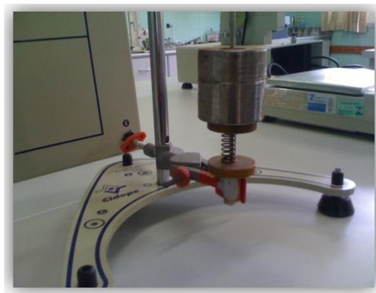
**Figura 9.** Equipamento utilizado para o procedimento experimental para dedução do coeficiente elástico  $k$  da mola.
