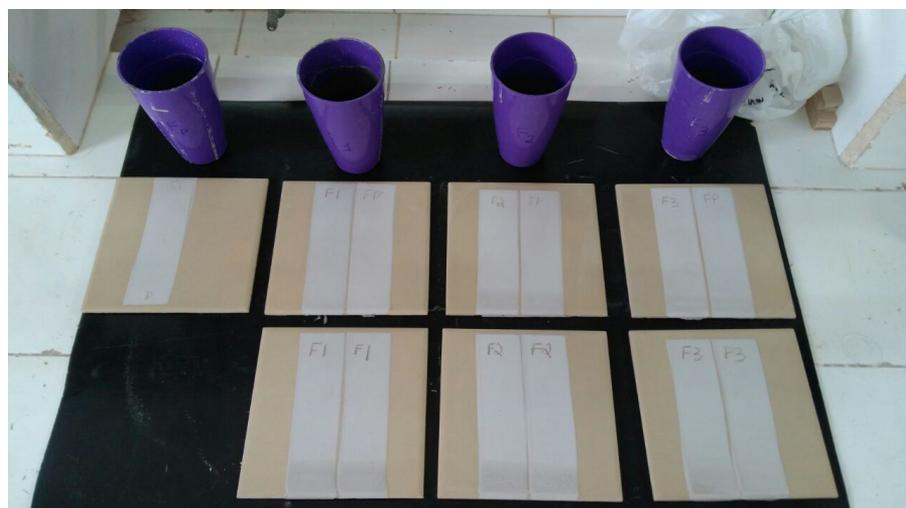
Figura 2. Peças cerâmicas com engobes. Fonte: Autores (2017).
