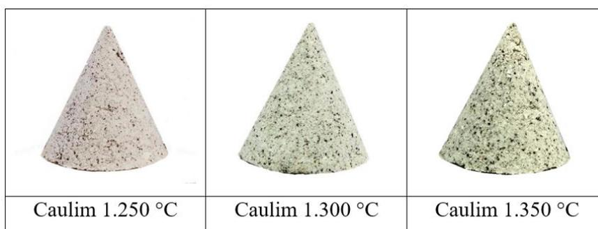
Figura 3. Cone de fusibilidade do caulim amostrado.
