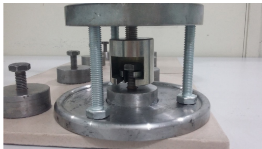
Figura 5. Dolly e pino sobre a placa cerâmica.
