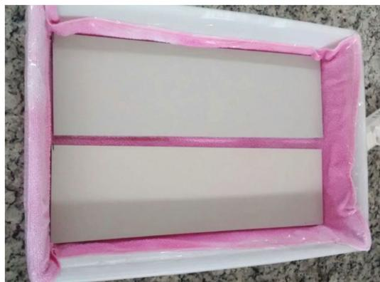
**Figura 15.** Teste prático para verificação do desenvolvimento de curvaturas nos porcelanatos na presença de umidade (efeito da expansão por umidade diferencial).
