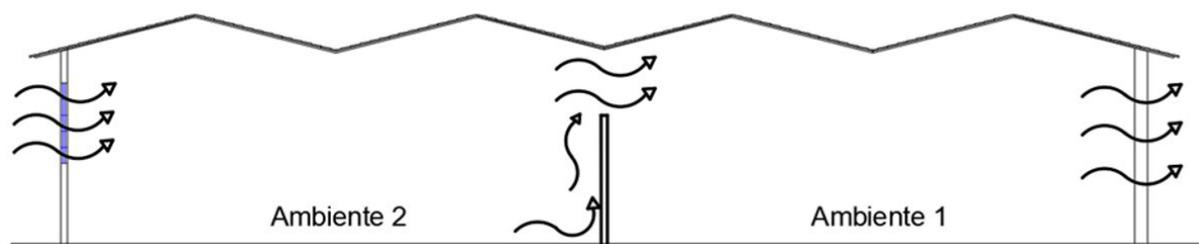
**Figura 10.** Corte esquemático da fábrica destacando os ambientes 1 e 2
