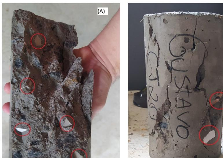
**Figura 5.** Interfaces vitrificadas do scrap cerâmico nos corpos de prova: (A) amostra de CS10 (B) amostra CT20
