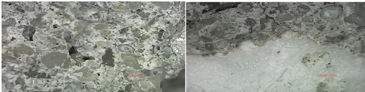
**Figura 4.** Micrografias das telhas de concreto (a) sem EPS e (b) com EPS
