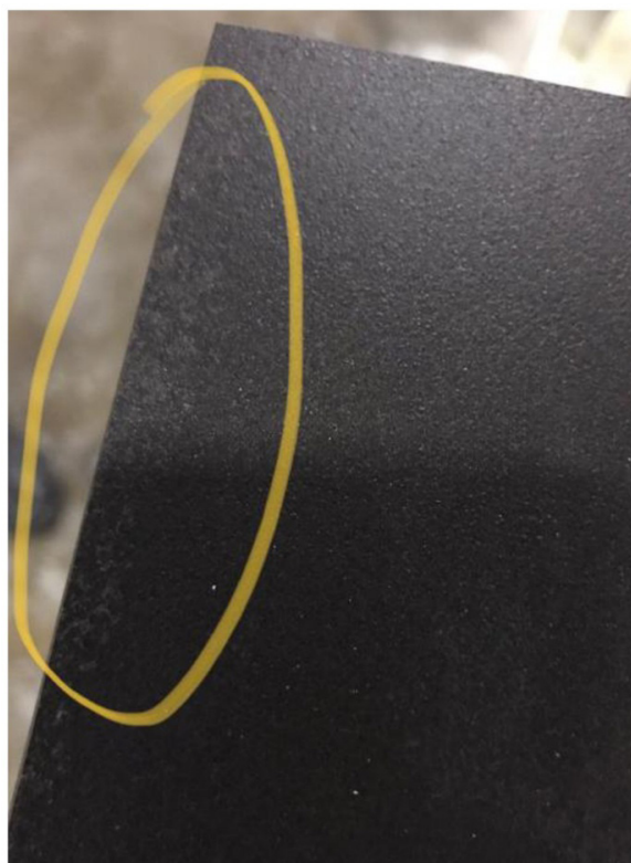
Figura 3. Exemplo defeito causado por excesso de água acumulada na lateral da peça
