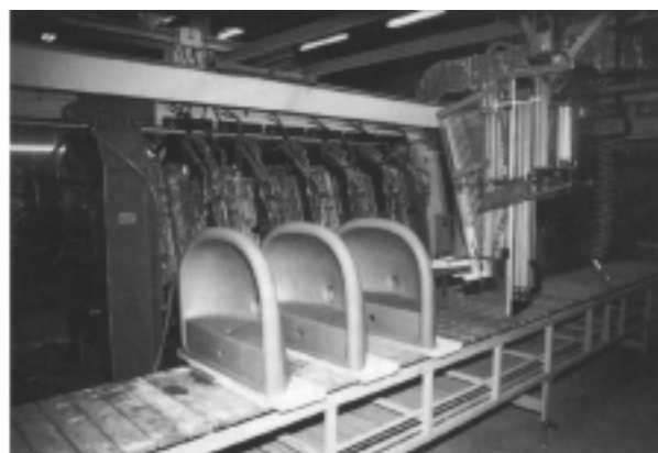
Figura 2. Visão geral da linha de fundição sobre pressão de bacias sanitárias.
