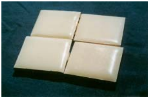
Figura 1. Revestimento com “pinholes”.
