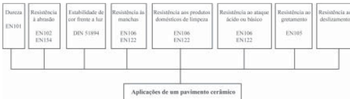
**Figura 3.** Características da superfície vidrada que definem as aplicações de um revestimento cerâmico.
