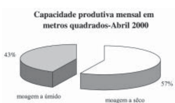
Figura 2. Capacidade produtiva (%) da Indústria de Revestimento Cerâmico, de acordo com o processo de moagem.
