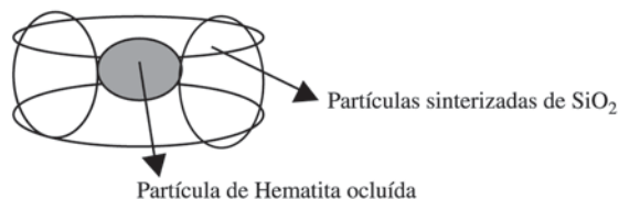
Figura 7. Mecanismo de oclusão de pigmentos encapsulados segundo trabalhos de LLUSAR (1999).
