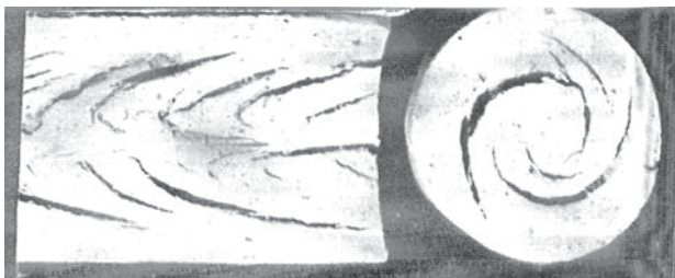
Figura 7. Fissurações provocada por laminações numa secção longitudinal do produto extrudado (à esquerda) e numa secção transversal (à direita).
