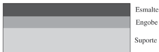
Figura 1. Representação esquemática das camadas que constituem os revestimentos cerâmicos esmaltados.
