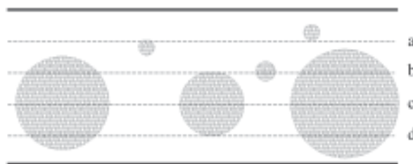
Figura 1. variação da porosidade em função dos cortes a , b , c e d ao longo da espessura da camada do vidro 12
