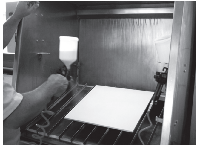
Figura 1. Aplicação da suspensão do aditivo sobre as peças de grês porcelanato.
