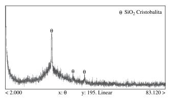
Figura 2. Difratograma da cinza utilizada como matéria-prima para a fabricação de isolantes térmicos.
