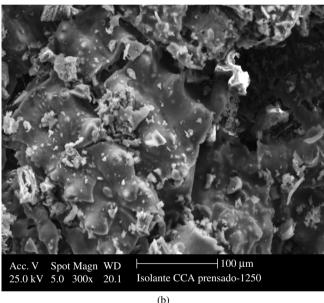
**Figura 6.** Microestruturas dos isolantes térmicos de cinza de casca de arroz. a) extrudado; e b)prensado.
