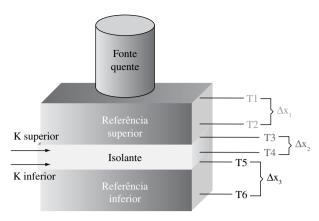
**Figura 4.** Esquematização do aparato experimental adotado para medição da condutividade térmica dos isolantes de CCA e do comercial fabricado a partir de sílica diatomácea.
