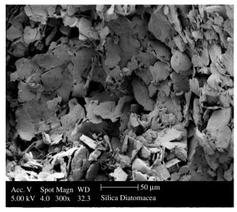
Figura 8. Microestrutura do isolante térmico comercial fabricado a partir de sílica diatomácea.
