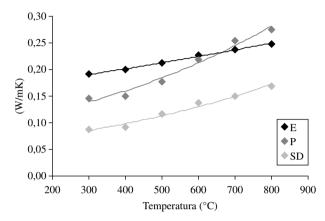
**Figura 7.** Valores de condutividades térmicas dos isolantes térmicos de cinzas, extrudados (E) e prensados (P), e de sílica diatomácea (SD).
