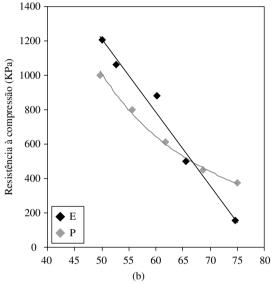
**Figura 5.** Propriedades físicas e mecânicas dos isolantes térmicos de cinza de casca de arroz, extrudados (E) e prensados (P).
