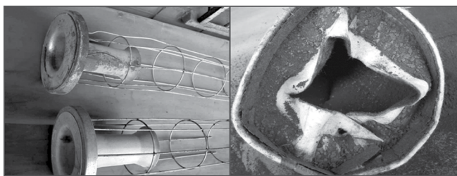
Figura 7. Oxidação acelerada por ataque ácido.
