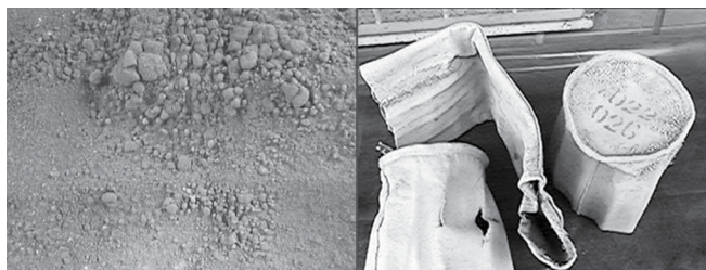
Figura 4. Efeitos da condensação de água nas mangas filtrantes.
