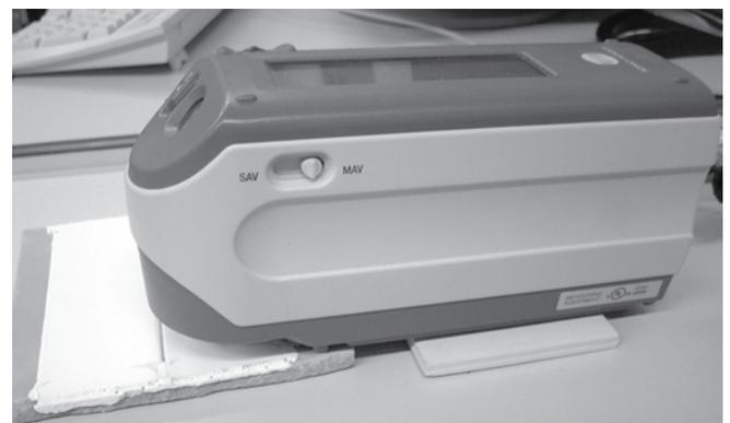
**Figura 3.** Imagens ilustrativas de um colorímetro ou espectrofotômetro de reflectância.
