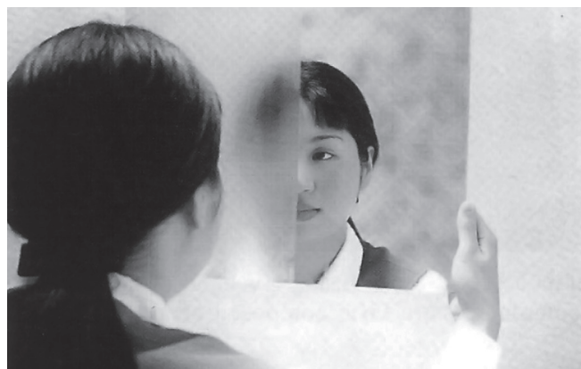
Figura 2. Efeito anticondensação de um revestimento fotocatalítico.
