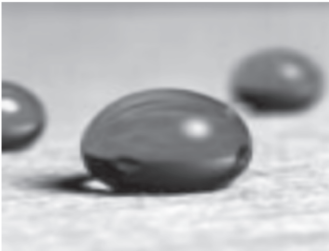
Figura 4. Formação de gota sobre uma superfície hidrofóbica.
