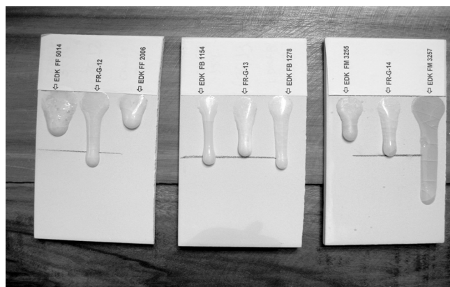
Figura 4. Resultado do teste de escorrimento comparando as fritas obtidas neste trabalho com fritas comerciais.
