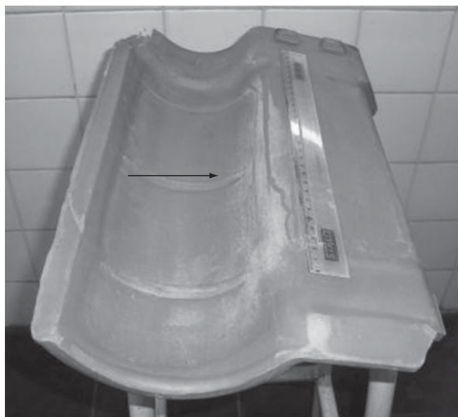
Figura 4. Telha com eflorescência, Piauí.
