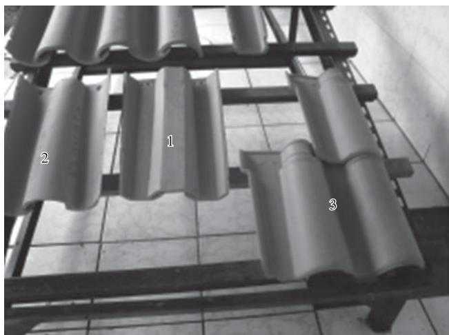
Figura 1. Telhas simples de sobreposição extrudadas tipo Piauí (1); colonial (2); telha composta de encaixe tipo portuguesa (3).
