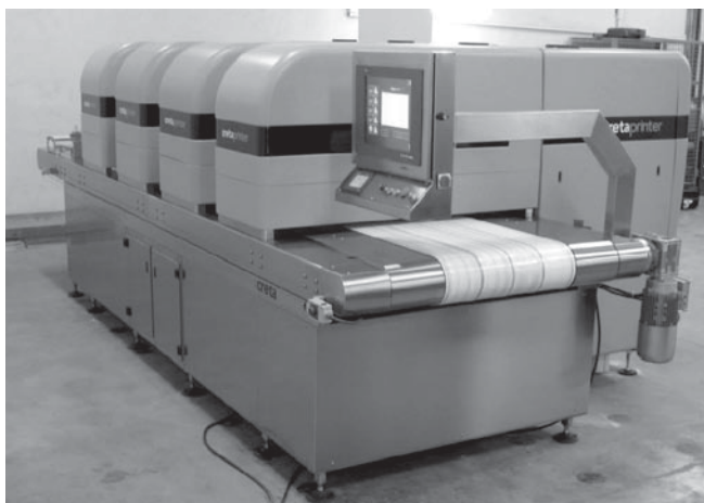
Figura 9. Exemplo de uma impressora comercial em linha de passagem única (Cretaprinter: imagem da Xaar plc).
