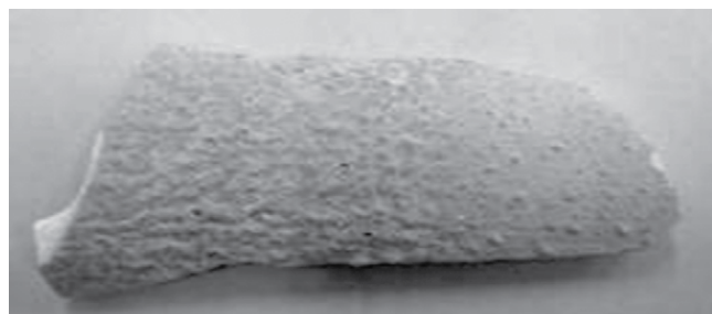
Figura 5. Peça de Rolo da zona de queima que quebrou na retirada (quarta retífica): presença de carepas de engobe da muratura e massa da placa.
