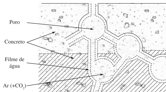
Figura 1. Representação esquemática da carbonatação parcial do concreto em estrutura porosa não saturada 22 .
