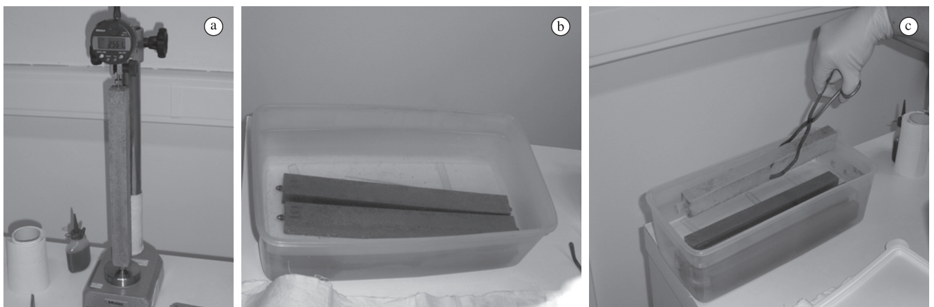
Figura 5. a) Aparelho para medida do comprimento dos corpos de prova, b) amostras em água a 80 \text{ }^\circ\text{C} e c) amostras em solução de NaOH (1N).
