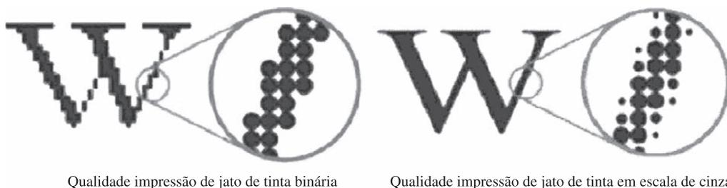
**Figura 11.** Detalhe da melhora de nitidez obtida com a impressão em escala de cinzas<sup>13</sup>.
