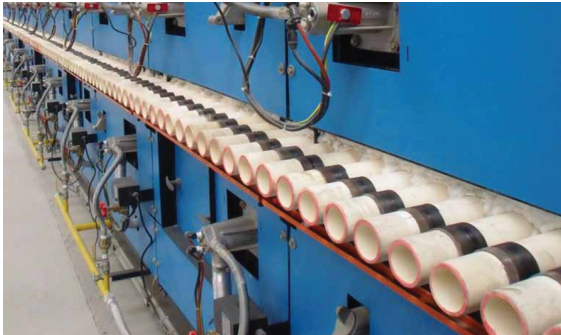
Figura 2. Detalhe dos rolos de um forno cerâmico.
