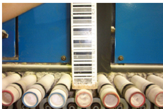
Figura 8. Detalhe do nivelamento com a mira sobre os rolos do forno.
