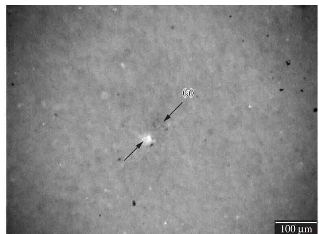
Figura 24. Fotomicrografia da depressão (a) no esmalte cerâmico produzido por contaminação de calcário incrustado na massa cerâmica do processo via seca de produção de pisos e revestimentos cerâmicos.
