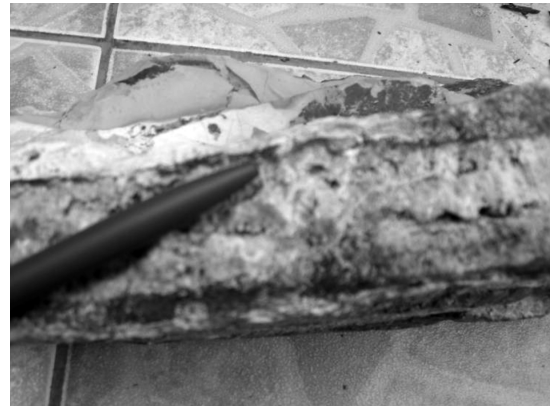
Figura 4. Foto do veio de carbonato e quartzo que preenche fratura na Formação Corumbataí, região de Rio Claro (SP), utilizado como aditivo.
