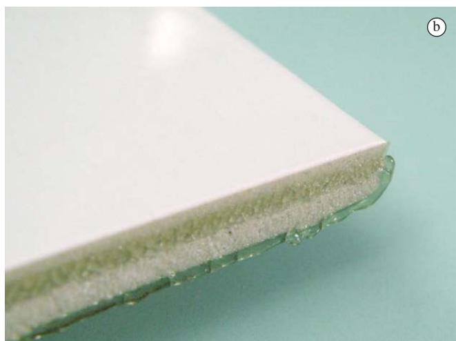
Figura 6. Corte laser: a) relação entre a velocidade e a espessura; b) aspecto da borda depois do corte.
