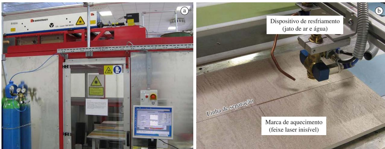
Figura 9. Equipamento laser de teste: a) visão geral; b) detalhe da zona de corte.
