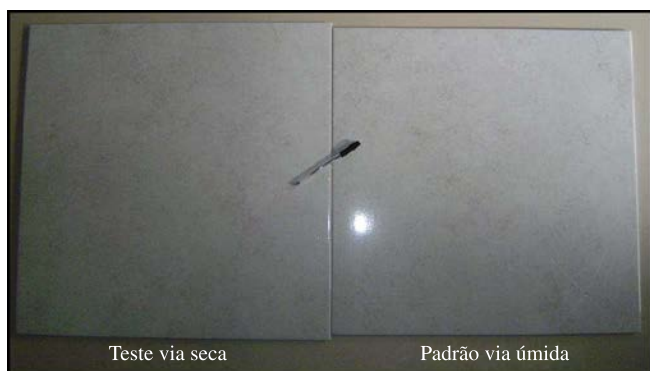
Figura 14. Imagens de porcelanatos 60 \times 60 \text{ cm}^2 produzidos por via seca e via úmida em testes semi-industriais.
