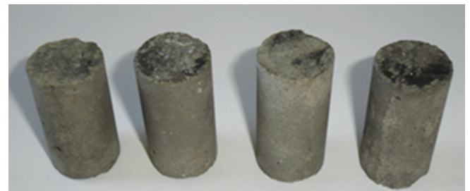
Figura 1. Corpos de prova de argamassa.
