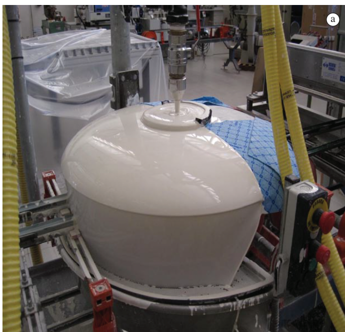
Figura 1. Cortina de esmalte semicircular gerada com uma campana convencional (esquerda) e esquema de funcionamento (direita).
