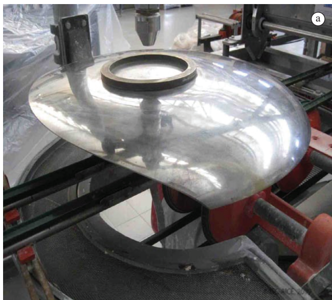
Figura 4. Campana com distribuição homogênea da quantidade de esmalte aplicado obtida pela usinagem de uma campana convencional (a) e placa metálica de controle (b).
