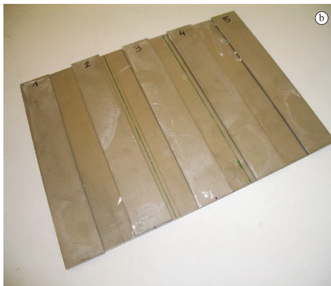
Figura 4. Campana com distribuição homogênea da quantidade de esmalte aplicado obtida pela usinagem de uma campana convencional (a) e placa metálica de controle (b).
