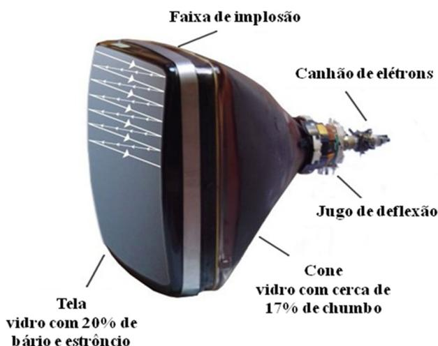
Figura 1. Componentes de um televisor CRT.
