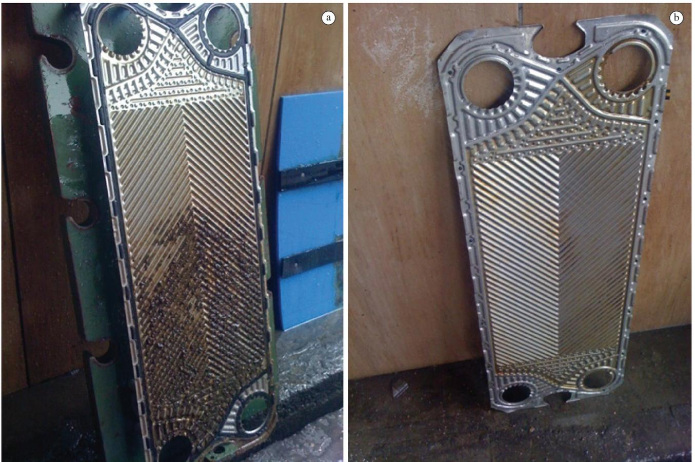
**Figura 6.** Limpeza do PHE: (a) metade da placa limpa e a outra metade ainda suja e (b) placa depois da limpeza.
