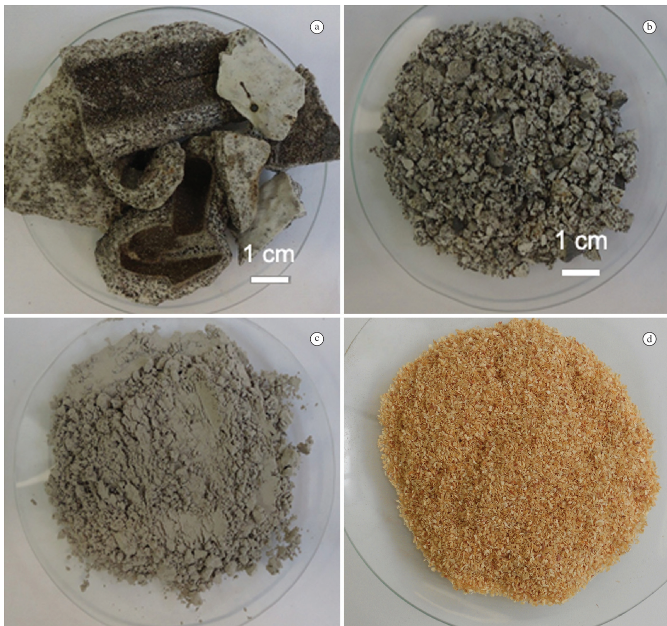
Figura 1. (a) Fotografias da casca cerâmica no estado de fornecimento; (b) da casca cerâmica triturada em um almofariz de aço; (c) da casca cerâmica móida em moinho de bolas; (d) da serragem de pinus.
