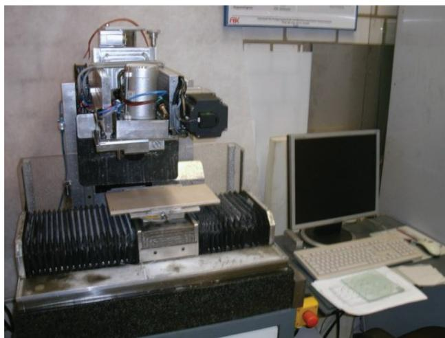
Figura 1. Máquina universal para ensaios de desgaste.
