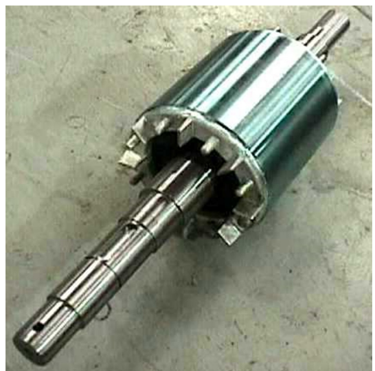
Figura 4. Rotor - motores de indução gaiola. Fonte: WEG Motores 2 .
