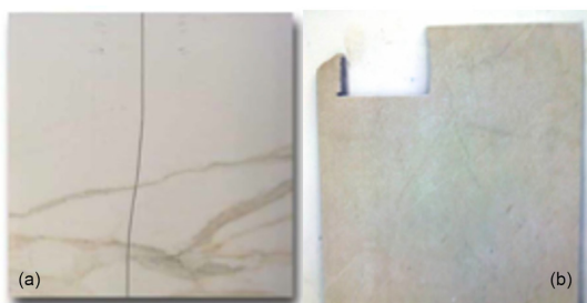
Figura 1. Cortes defeituosos em porcelanatos: (a) com cortador manual e (b) com cortador de disco a úmido.
