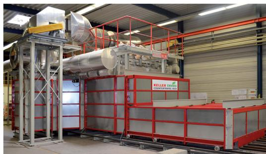
Figura 6. Instalação do forno de testes Enviro. Fonte: Keller HCW GmbH, Alemanha.
