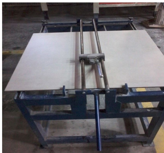
Figura 3. Equipamento para corte das peças. Fonte: Autor.
